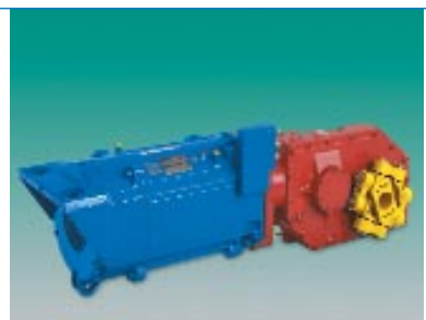
Beim Längsantrieb ist die Antriebseinheit Getriebe-Fahrmotor außerhalb des Drehgestells zwischen den beiden Radsatzwellen angeordnet. Jeweils eine Antriebseinheit treibt eine Radsatzwelle. Das Getriebe beinhaltet in diesem Fall eine Kegelradstufe. Die Einbaulage des Motors im Längsantrieb ist um 90° gegenüber der im Querantrieb gedreht, so dass die Motorbreite 350 mm beträgt. Das kommt dem Einbauvolumen im Rahmen des gegebenen Lichtraumprofils entgegen. Als Längsantrieb sind diese Motoren für die Niederflurstraßenbahnen „Flexity Outlook“ für Eskisehir (Türkei), Genf und Brüssel vorgesehen.
