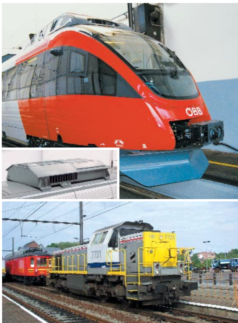
Ein Hochgeschwindigkeitszug der österreichischen Bundesbahn (oben). In seinem Dachaufbau stecken VEM-Hilfsmotoren (Mitte). Die neue dieselhydraulische Lok HLD 77C (unten).
