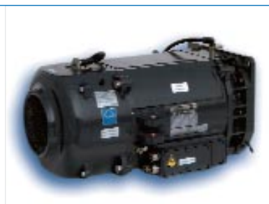
Als so genannter Spezialantrieb ist der Motor fast vertikal am Fahrzeugrahmen der „Monorail“ Las Vegas befestigt. Am D-seitigen Lagerschild befindet sich die Motoraufhängung. Das Drehmoment wird mit einer Kardanwelle zum quer im Fahrzeug liegenden Getriebe übertragen. Das N-seitige Lagerschild nimmt den Fremd Lüfter auf, der von einem Außenläufermotor angetrieben wird. Dadurch ist es gelungen, einen äußerst kompakten fremdbelüfteten Motor zu realisieren, der bis in Drehzahlbereiche von 6000 min -1 sehr hohen Geräuschanforderungen genügt.
