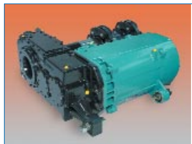
Beim Querantrieb ist die Antriebseinheit Getriebe-Fahrmotor innerhalb des Drehgestells angeordnet. Auf der Getriebeseite hat der Motor kein eigenes Lagerschild, sondern ist direkt an das Getriebe angeflanscht. Als Querantrieb werden die Motoren in den Niederflurstraßenbahnen „Flexity Classic“ mit unterschiedlichen Leistungen in Dessau, Dresden, Halle und Frankfurt/Main erfolgreich eingesetzt.
