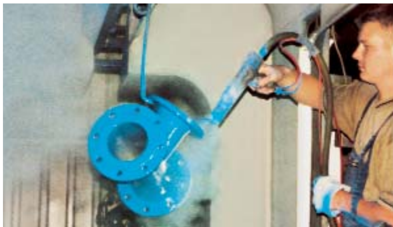
Werner Henryk bei der Oberflächenbehandlung von Gussteilen
