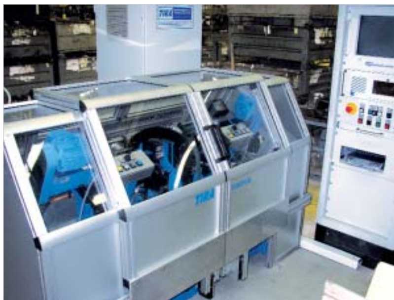
Wuchtmaschine mit automatischer Abbohrreinheit
