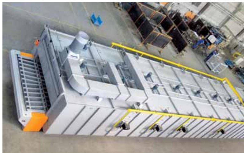
Eine Dekorbrennbahn, in der Dekore auf Flaschen und andere Gläser aufgebrannt werden
