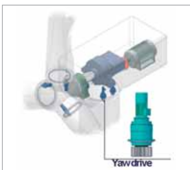
Oben: Die Gondel wird mit vier Antrieben bewegt. Rechts: B21R 112 MX 6 mit Zykloid-Präzisionsgetriebe
