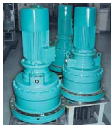
Oben: Die Gondel wird mit vier Antrieben bewegt. Rechts: B21R 112 MX 6 mit Zykloid-Präzisionsgetriebe
