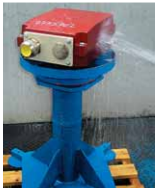
Bild 1: Prüfanordnung zum Nachweis der Einhaltung der Schutzart IP X5 (Strahlwasser)
