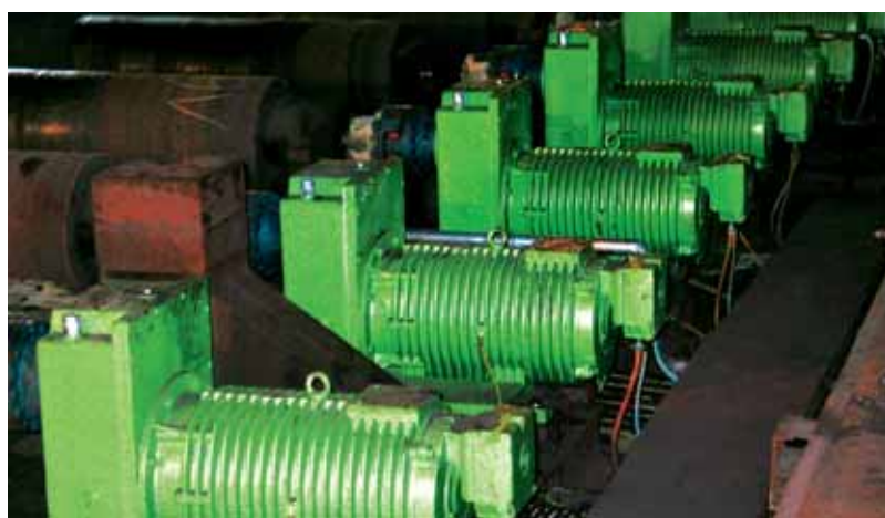
oben: versandfertige VEM-Rollganggetriebe; unten: fertig montierte Antriebe in der Trägerstraße
