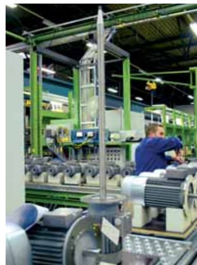
Bild 4: Thomas Gottschlich beim Prüfen von Spezialmotoren, die zum Einsatz kommen in Rührwerken, als Bremsmotoren in Windkraftanlagen oder als Anbaumotoren für Getriebe
