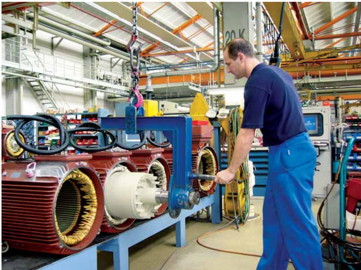
Monteur Olaf Giese fügt einen Läufer in den Stator ein. Der Motor komplettiert Strahlflüster für Tunnelentlüftungsanlagen.
