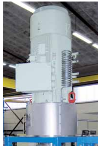
Bild 2: Spezialmotor für Flüssiggaspumpen, Baugröße 355
