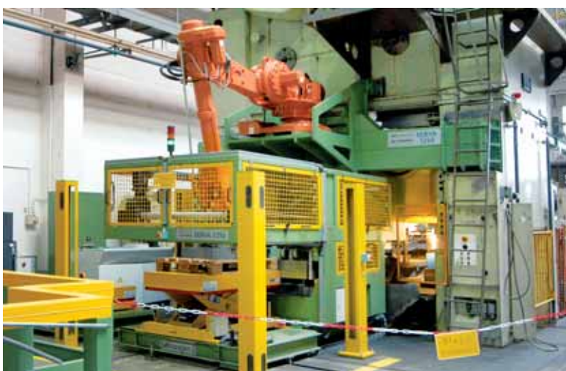
Die Bandverarbeitungsanlage in der Stanzerei ist mit einem Industrieroboter aufgerüstet worden.
