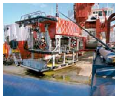
Der Tiefseeroboter Quest wird für den Einsatz vorbereitet.
