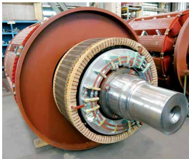
Der Läufer mit Erregerteil für einen Synchrongenerator ist für eine Doppelendfähre in Kanada bestimmt.
