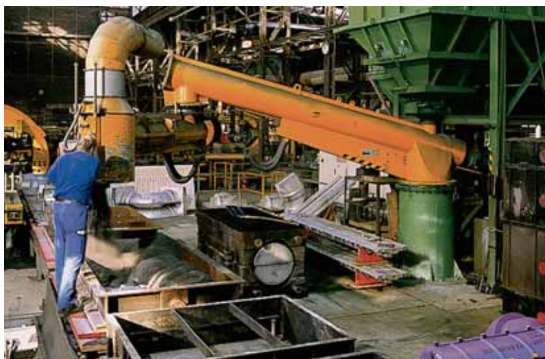
Die Mischerlinie in der Handformerei mit Durchlaufmischer (30 t/h)
