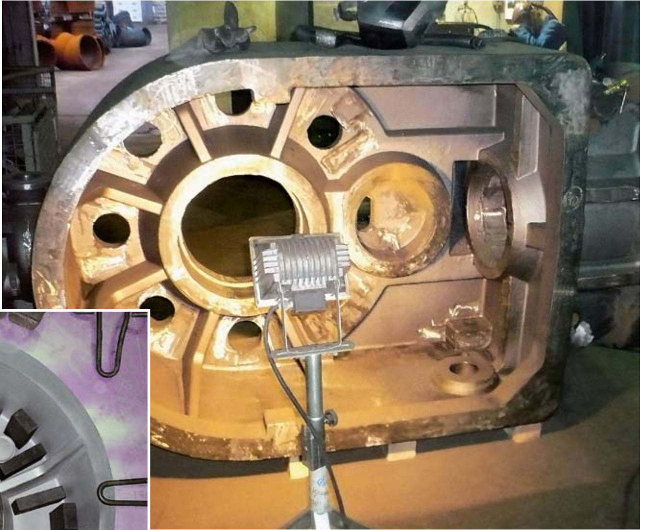
Das Gussteil Planetengetriebegehäuse ist mit 4.330 Kilogramm das schwerste Gussteil, das in der Keulahütte gefertigt wird.
