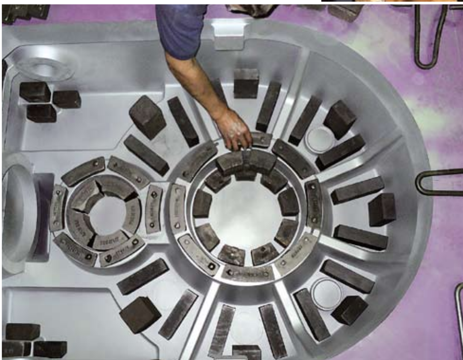
Die Form für das Getriebegehäuse wird vorbereitet.
